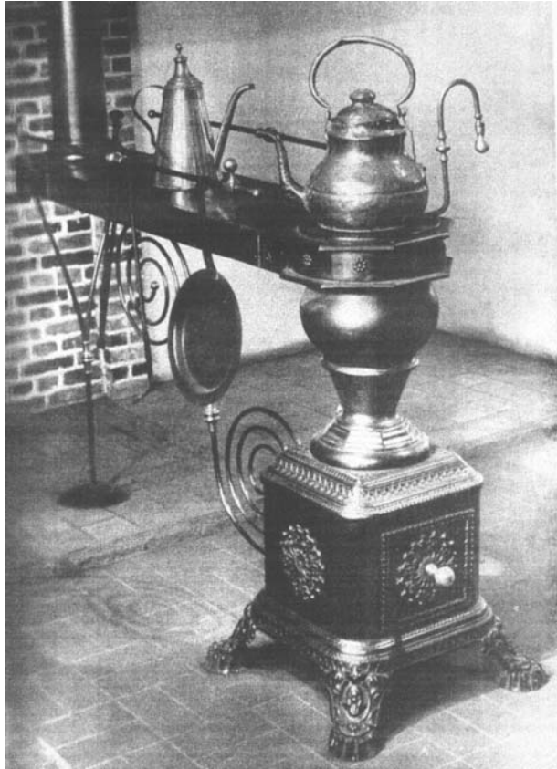
Plattebuiskachel uit herberg 'De Pot' te Grimbergen. Dit is een zeer oud model zonder oven. De rookafvoer gaat niet recht in de muur, maar langs een ronde pijp naar boven.
